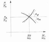
Fig. 18. — Variation relative des couples moteurs et résistants en fonction de la vitesse angulaire du groupe.
