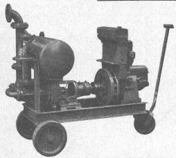
Débits de 1 à 500 litres/seconde. — Pas de soupape de pied, ni de clapet dans la tubulure d'aspiration. — Aucune pompe à vide de secours. — Réamorçage automatique immédiat, même si de l'air est entré dans le tuyau d'aspiration. — Pas de surfaces de contact à frottement et s'usant; par conséquent pas de contretemps même pour l'élévation de la boue, du sable ou du gravier.
