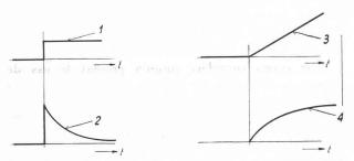
Fig. 17. — Courbe de réponse du régulateur différentiel.
