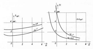
Fig. 5 b: Détermination de  $b_{\rm opt}$  en fonction de a avec le coefficient de charge  $\lambda_{\theta}$  comme paramètre.
