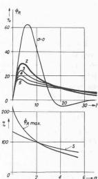
Fig. 9. — Influence du facteur de sensibilité des couples par rapport aux écarts de fréquence (facteur a) sur la tenue de la fréquence,
