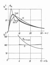
Fig. 6. — Influence de la constante d'accélération  $T_a$  sur la tenue de la fréquence.
