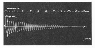
Fig. 17. — Diagramme de l'oscillation propre d'une tour.
