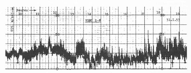
Fig. 18. — Diagramme d'enregistrement représentant un vent fort et irrégulier, avec violentes rafales.
