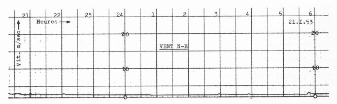
Fig. 19. — Diagramme d'enregistrement d'un vent faible et persistant (bise).
