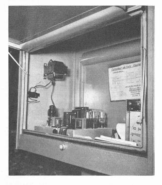
Fig. 1. — Compteur automatique de Founex du type magnétique.
