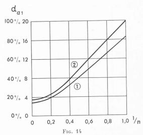
Exemple no 3:  $\phi > 0$  Q = -0.436. Variation de l'effet des dispositifs amortisseurs de l'alternateur.
