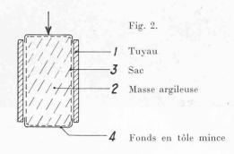
au diamètre interne du tuyau est rempli soigneusement d'une pâte ferme d'argile plastique.
