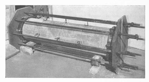
Fig. 1. — Dispositif d'essai d'un tuyau en fibro-ciment. Diamètre : 40 cm ; longueur : 200 m. Publication Nº 148 du Laboratoire fédéral d'essai des matériaux et Institut de recherches, Zurich 1944.
