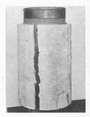
Fig. 3. — Tuyau après rupture.
