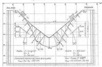
Fig. 22. — Déformation de la cuvette d'un lac à grande distance à l'amont du barrage.
