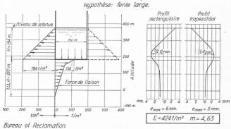
Fig. 27. — Déformation de la cuvette d'un lac : Calculs du « Bureau of Reclamation » (cas d'une fente large).
