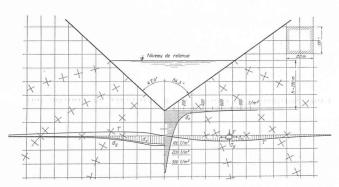
Fig. 24. — Déformation de la cuvette du lac. Interprétation de l'essai de photo-élasticité.
