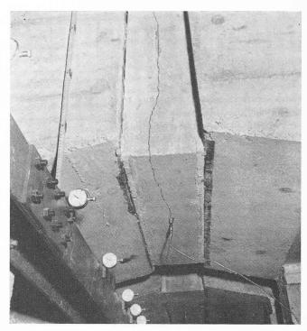
Fig. 17. — Photographie des vérins capsulaires avec le dispositif de mesure des déformations. Le vérin a été gonflé.
