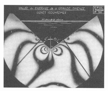
Fig. 23. — Déformation de la cuvette du lac. Essai de photoélasticité.
