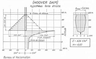
Fig. 26. — Déformation de la cuvette d'un lac : Calculs du « Bureau of Reclamation » (cas d'une fente étroite).
