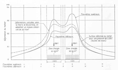
Fig. 18. — Surface déformée du rocher sous une pression de 1500 tonnes.
