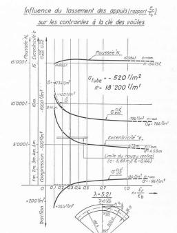
Fig. 20. — Influence du tassement des appuis sur les contraintes à la clé des voûtes.
