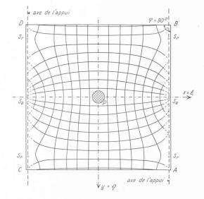
Fig. 17. — Plaque  $\varphi = 90^{\circ}$ . Trajectoires des moments principaux.
