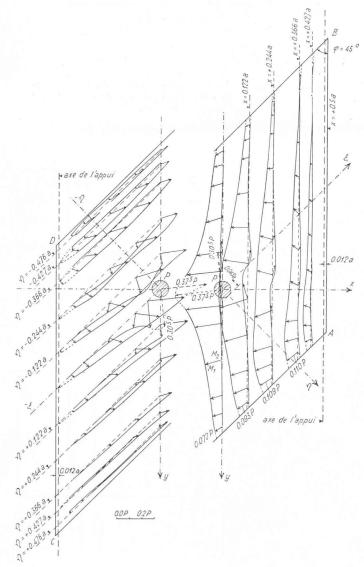
Fig. 20. — Plaque  $\phi = 45^{\circ}$ . Diagrammes des moments principaux.
