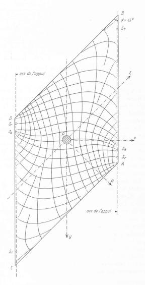
Fig. 18. — Plaque  $\varphi = 45^{\circ}$ . Trajectoires des moments principaux.
