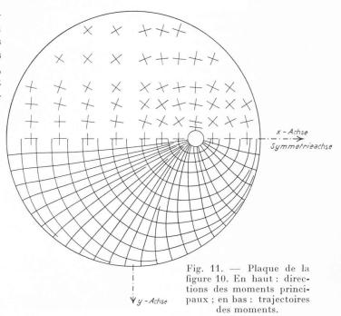
aux points où ont été faites les mesures; en bas, les trajectoires des moments, dessinées en se basant sur ces directions. Les grandeurs et les directions des moments principaux sont représentées par les flèches de la figure 12 15. On remarquera la rapide augmentation des moments, lorsqu'on s'approche de la petite surface d'application de la force  $P^{16}$ .
