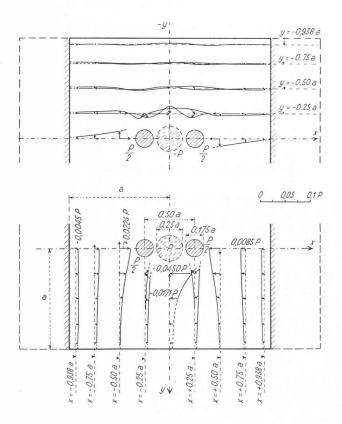
Fig. 23. — Cas où la résultante générale et le couple résultant du système de forces appliquées sont nuls.
