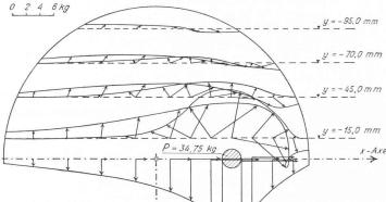
Fig. 12. — Répartition des moments principaux dans la plaque de la figure 10.
