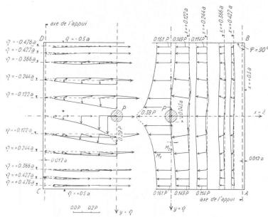
Fig. 19. — Plaque  $\phi = 90^{\circ}$ . Diagrammes des moments principaux.
