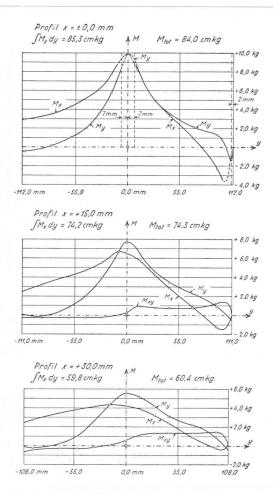
c) Plaque circulaire reposant en trois points et sous l'action d'une force P, perpendiculaire aux faces, appliquée au centre.
