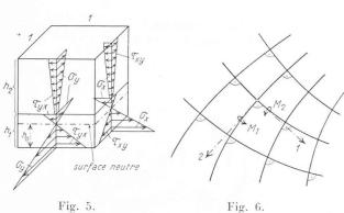
$^3$  Il existe, en outre, des tensions tangentielles  $\tau_{xz}$  et  $\tau_{yz}$  réparties paraboliquement dans l'épaisseur de la plaque, mais qui sont, en général, petites par rapport à  $\sigma_x$ ,  $\sigma_y$  et  $\tau_{xy}$ . Ces tensions peuvent être négligées, sauf au voisinage des points où agissent des forces concentrées. Il en est de même des tensions normales  $\sigma_z$ .
