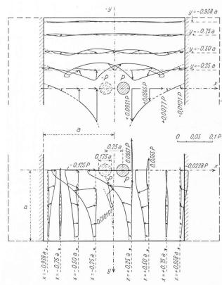
Fig. 22. — Cas où la résultante générale du système de forces appliquées est nulle, mais où le couple résultant est différent de zéro.
