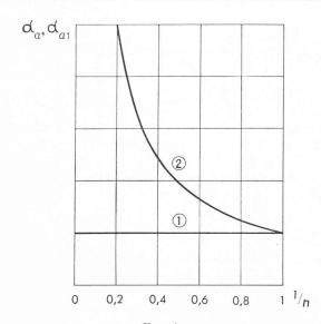
Fig. 1. Variation supposée des coefficients  $a_{a_1}$  et  $a_a$  caractérisant l'effet des dispositifs amortisseurs de l'alternateur.
