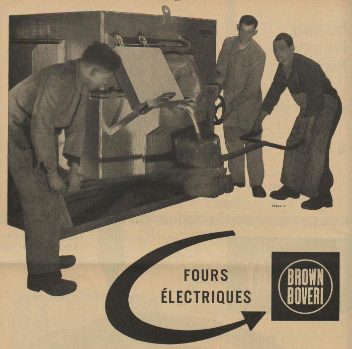
De notre programme de fabrication pour la fonderie Fours oscillants à électrodes de graphite pour les alliages de cuivre d'une capacité jusqu'à 1000 kg • Fours de coulée à induction pour l'aluminium et les alliages de cuivre • Fours à induction à creuset pour la fusion et le réchauffage • Fours à creuset de puisement chauffés par résistances pour l'aluminium et le laiton.
