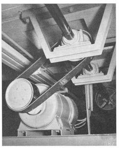
Fig. 4. — Transmission de 18 CV par une poulie excentrée.
