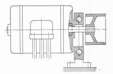
Fig. 9. — Construction appropriée et disposition d'un moteur excentré.
