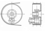
Fig. 10. — Poulie motrice excentrée avec système à auto-tension.
