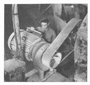
Fig. 14. — Entraînement de 38 CV d'un concasseur à pierres. La poussière diminue le coefficient d'adhérence et malgré tout l'entraînement ne patine jamais.
