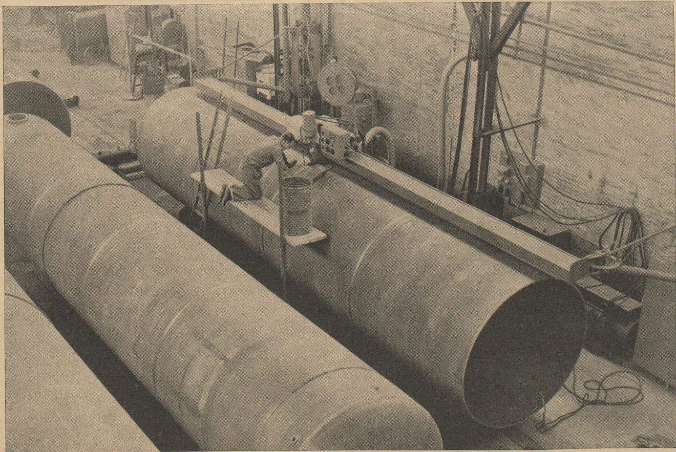
Les têtes automatiques Brown Boveri de soudage à l'arc permettent d'exécuter des conduites forcées soumises aux réceptions officielles.
