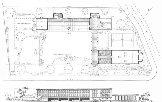
Plan du rez-de-chaussée et façade sud-est. — Echelle 1:900.
