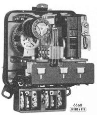
Fig. 10. — Récepteur pour 3 doubles-commandes.
