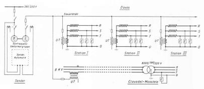
Fig. 7. — Injection en série sur basse tension dans le réseau de Davos et injection simultanée sur 8 kV.
