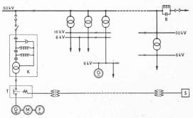
Fig. 8. — Injection en parallèle sur haute tension. GMF = groupe convertisseur; T = contacteur d'émission; K = filtre de couplage; B = circuit-bouchon; S = tableau de commande.
