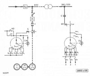
Fig. 1. — Schéma de principe des systèmes à intervalle d'impulsions.
