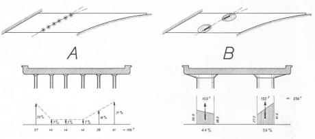
Fig. 11. — Réaction de la dalle sur la palée ; surcharge 1 t/m². A. Avant-projet, palée comprenant 6 colonnes. B. Projet exécuté.
