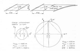
Fig. 29. — Efforts au milieu de la travée occidentale comparés à ceux d'une dalle isolée de mêmes dimensions.
