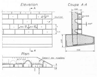
Fig. 13. — Schéma du moellonnage des culées.
