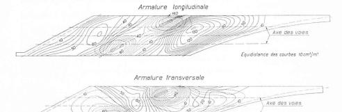
Fig. 21. — Densité de l'armature exprimée en cm²/ml.
