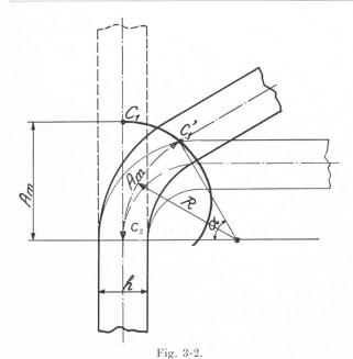
déformations pendant toute la durée de l'essai. Le choix de la longueur de cette zone et son rapport à l'épaisseur de l'éprouvette (autrement dit le volume relatif du métal engagé dans l'essai) est basé sur des considérations théoriques, ainsi que sur les données de l'expérience. Une modification arbitraire de cette zone entrainerait les mêmes conséquences que la modification de la longueur des éprouvettes standardisées de traction, c'est à dire fausserait complétement les résultats des essais.
