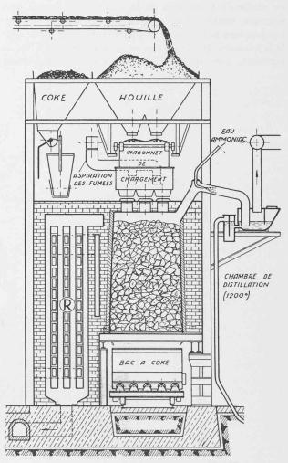
Fig. 3. — Coupe transversale d'un four à travers une chambre et le récupérateur.
