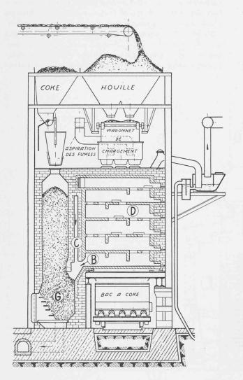
Fig. 2. — Coupe transversale d'un four par le gazogène.
