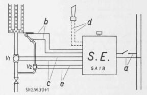
Fig. 14. — Dispositif Cipag de sécurité dit « électronique » basé sur l'effet de ionisation de la flamme.
