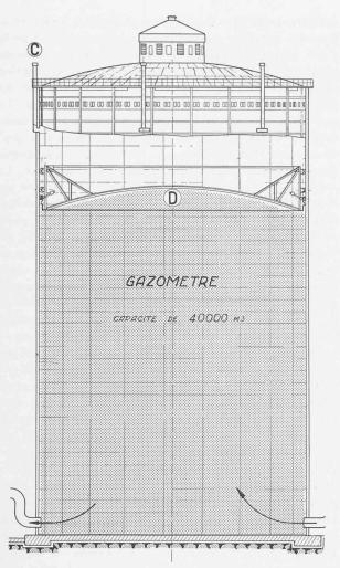
Fig. 7. — Coupe générale d'un gazomètre sec, syst. Klönne.
