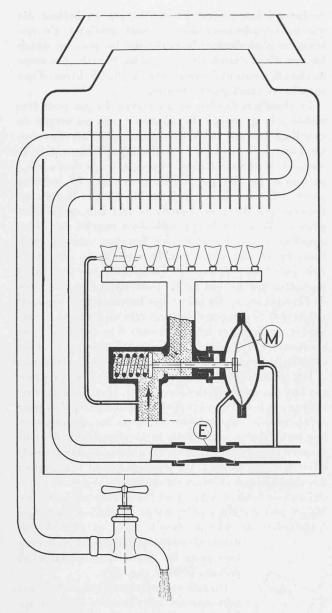
Fig. 9. — Schéma d'un appareil instantané pour la préparation de l'eau chaude.
