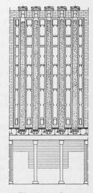
Fig. 4. — Coupe longitudinale d'un four.
