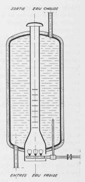
Fig. 10. — Appareil à accumulation d'eau chaude.
