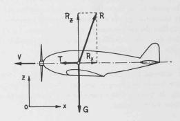
Fig. 2. — Avion en vol horizontal à vitesse uniforme.
