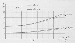
Fig. 5. — Effet de l'épaisseur du profil sur une grille de faible inclinaison.
