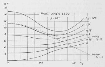
Fig. 2. — Caractéristiques expérimentales d'une grille comparées aux théories de Weinig et Weinel.
