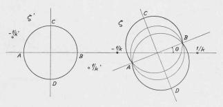
Fig. 4. — Représentation conforme d'un profil épais.
