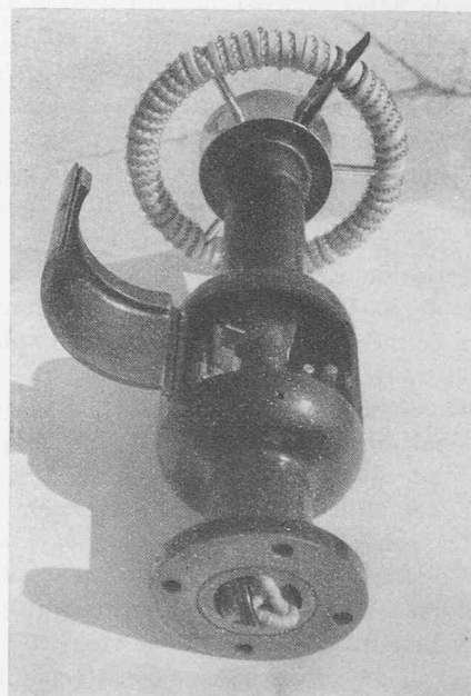
Fig. 3. — Le corps de chauffe à l'intérieur du robinson, concentrique au miroir réfléchissant la chaleur radialement vers les aubes. La porte de révision du boîtier où est logé le contacteur est ouverte.
