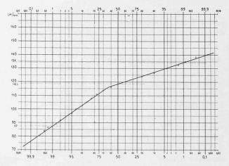
Fig. 2. — Courbe de fréquences cumulées du gradient moyen du module de réfraction mesuré entre le Chasseron (1590 m) et Neuchâtel (487 m). L'abscisse donne, en pourcent du nombre total d'observations, le nombre de mesures où le gradient dépasse la valeur portée en ordonnée.
