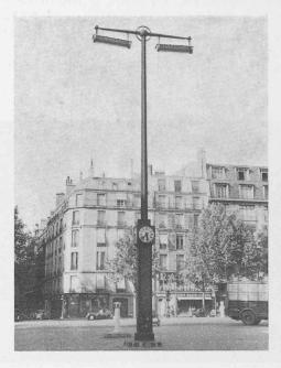
Fig. 5. — Candélabre double (avenue de la Grande-Armée). 2 appareils à 4 lampes Sylvania de 100 watts, 1,50 m.
