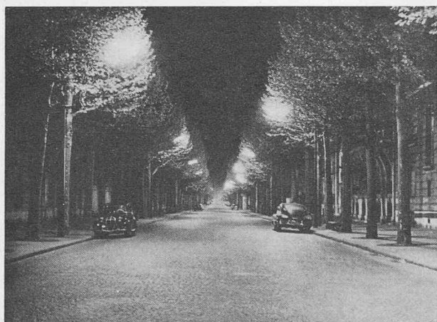
Photo Neuhaus. Fig. 12. — Avenue Victor-Hugo (Paris) éclairée par appareils Neuhaus à 3 lampes Visseaux 40 watts. Flux par appareil : 7500 lumens.
