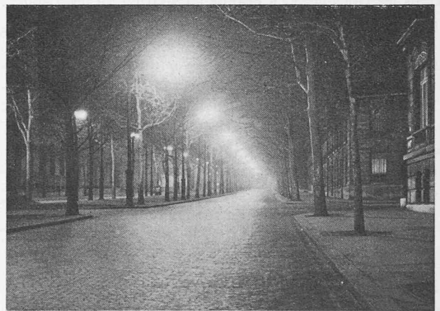
Fig. 11. — Avenue du Président-Wilson éclairée par appareils Philips à 3 lampes de 40 watts.
