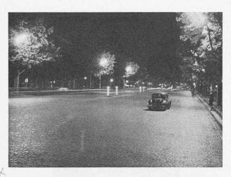
Fig. 6. — Avenue de la Grande-Armée éclairée en fluorescence. Appareils Neuhaus à 4 lampes Sylvania de 100 watts. Flux: 18 000 lumens.
