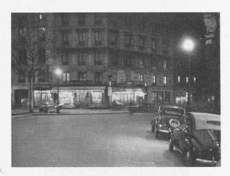
Fig. 15. — Place de Rennes (Paris) éclairée par lampe ballon fluorescente. 18 000 lumens.
