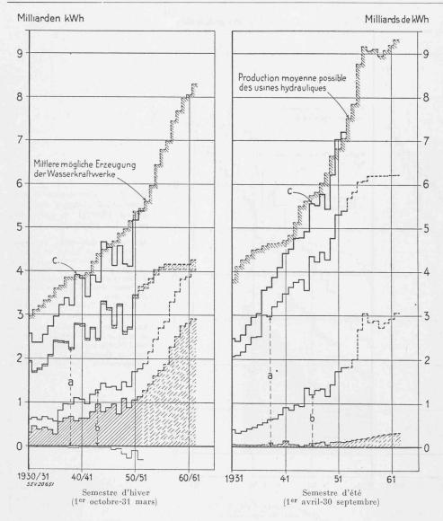
Fig. 1. — Production d'énergie techniquement possible et effective de toutes les usines hydrauliques.
