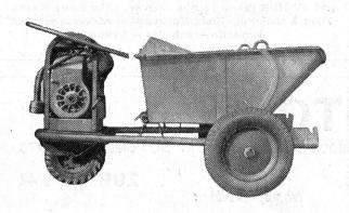
Pour benne de 250 litres ou plateforme de 600 kg. de charge utile. Moteur de 2,4 HP. refroidi par air. Utilisable dans l'industrie ou sur les chantiers de génie civil.
