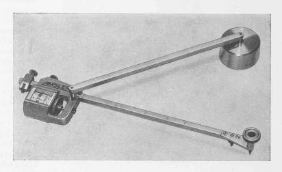
Fig. 9. — Planimètre moderne avec compteur intégrant. Les lectures sont grandement facilitées par rapport à l'instrument de la figure 5.
