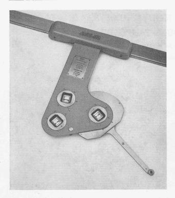
Fig. 10. — Intégrateur pour la détermination des surfaces, des moments statiques et de moments d'inertie.
