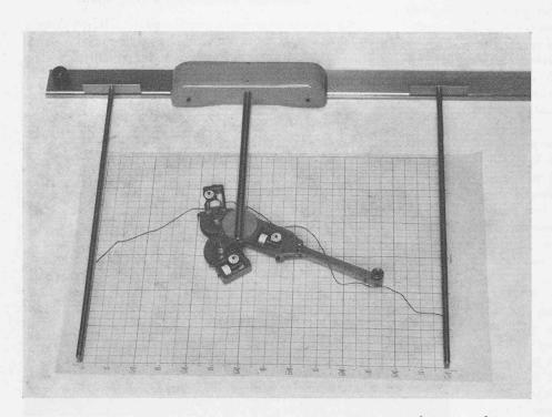
Fig. 8. — Intégrateur pour détermination des surfaces et des intégrales  $\int y^{1/2} dx$  et  $\int y^{3/2} dx$ . (Instrument spécial pour recherches de mécanique des fluides.)
