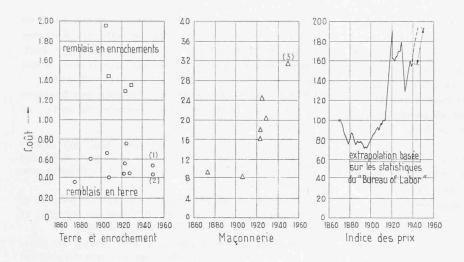
Fig. 5. — Coût en dollars par yard cube (0,765 m³) des remblais en terre (earth fill), en enrochements (rock fill) et des barrages en maconnerie comparé avec l'indice des prix (Snyder-Tucker; 1913 = 100 %).
