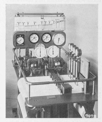
Fig. 7. — Table d'enregistrement pour voiture dynamométrique. En avant à droite, les manomètres enregistreurs pour mesures de freinage; en arrière de la bande de papier, les appareils mathématiques; au dernier plan, les instruments à cadran et l'indicateur de parcours.
