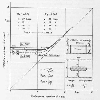
Fig. 18. — Courbes  $\tau_{am.} = f(\tau_{av.})$ . Courbes théoriques et courbes déduites des essais. Chenal de 30 cm de largeur avec un pilier, et un radier plat. (Valeurs relatives.)
