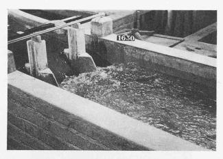
Fig. 22. — Ecoulement à travers le modèle correspondant à la crue maximum de 18 000 m³/sec. Sur le graphique de la figure 21, cet écoulement serait caractérisé par le point A. Niveau amont 46,60 Niveau aval 45,60
