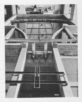
Fig. 20. — Vue générale de l'installation. B et D : limmimètres pour mesurer les niveaux d'eau. Le bassin A sert a tranquilliser l'eau venant des pompes pour obtenir une répartition uniforme des vitesses à l'amont du barrage. L'eau traverse le modèle, C, puis est restituée au bassin des pompes.
