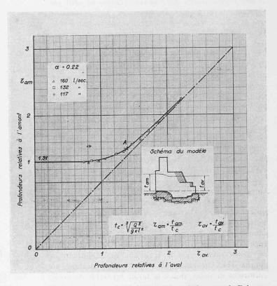
Fig. 21. — Courbe  $\tau_{am.}=f\left(\tau_{av.}\right)$  valable pour le barrage de Belver.
