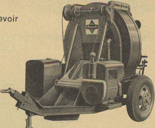
La préparation du SABLE D'ÉPANDAGE, de matériel gelé pour des MÉLANGES DE BÉTON ET DE MORTIER par des températures très basses et beaucoup d'autres travaux peuvent être exécutés pendant les mois d'hiver à l'aide du Barber-Greene MIXALL.
