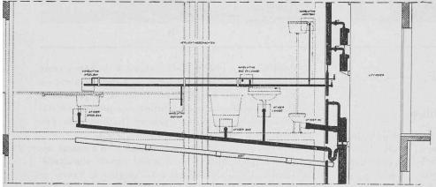
Tous les services généraux de gaz, électricité, eau courante, froide et chaude, évacuation des eaux usées, chauffage, etc., ont été réunis dans un espace restreint à l'arrière de la cage d'ascenseur. La dimension totale de ce bloc vertical n'excède pas 1,40 × 0,50 m. L'encombrement du bloc horizontal (alimentation) n'ex-
