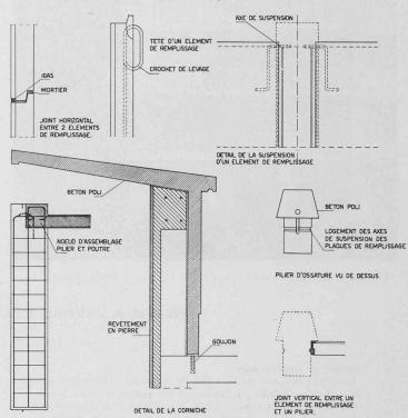
Fig. 69. — Détails divers de fabrication. Echelle 1:30.
