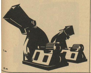
Ventilateurs d'air secondaire pour une installation de chaudières en Belgique
