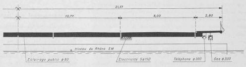
Fig. 6. — Demi-pont amont bras gauche, coupe transversale.
