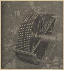
La chaîne est construite pour une usure lente et minime Longue durée, même à des vitesses élevées. La plus grande et uniforme précision est assurée dans toute longueur de chaîne, coussinets et rouleaux sans joints : Point de défectuosités et d'interruptions Les roues avec profil des dents RENOLD : Engrenage
