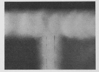
La résilience moyenne d'une soudure automatique faite en une ou deux passes, indépendamment des passes faites à la main, est d'environ 7 kgm/cm².
