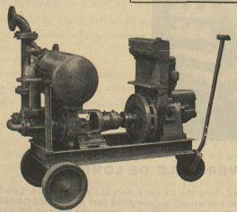
Débits de 1 à 500 litres/seconde. — Pas de soupape de pied, ni de clapet dans la tubulure d'aspiration. — Aucune pompe à vide de secours. — Réamorçage automatique immédiat, même si de l'air est entré dans le tuyau d'aspiration. — Pas de surfaces de contact à frottement et s'usant; par conséquent pas de contretemps même pour l'élévation de la boue, du sable ou du
