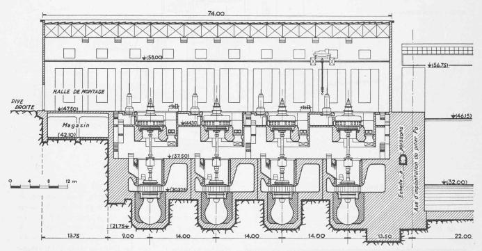
Fig. 10. — Usine. Coupe verticale dans l'axe des turbines.
