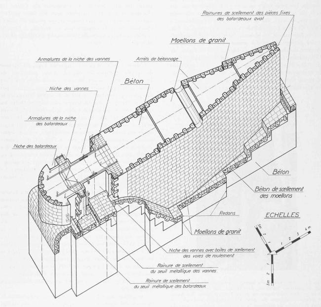
Fig. 7. — Vue perspective d'un pilier en construction.
