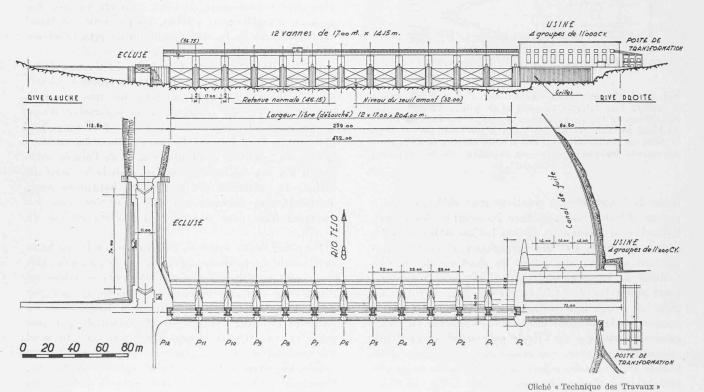
Fig. 5. — Plan d'ensemble et élévation vue d'amont.
