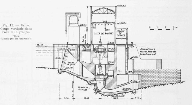
bines de Belver, travaillant seules ou ensemble, peuvent utiliser des débits du Tage variant de 30 à 300 m³/sec, sous des chutes de 15,50 m à 10,00 m avec un rendement supérieur à 88 % 1. La vitesse de rotation des groupes est de 167 tours par minute.
