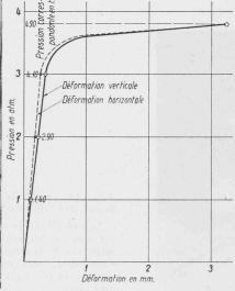
Fig. 14. — Essai d'un tuyau ovoïde légèrement armé.
