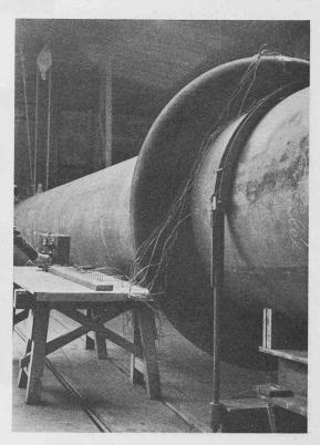
Fig. 16. — Pulsateur 30 t. Essai de fatigue aux flexions répétées d'une traverse spéciale pour wagon de chemin de fer. Sollicitations poussées jusqu'à fissuration du bec, obtenue après des déformations très apparentes.
