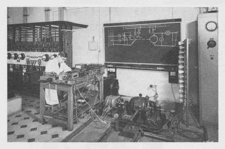
Fig. 23. — Mesure de la puissance d'un moteur électrique, triphasé, d'une puissance nominale de 2 CV.
