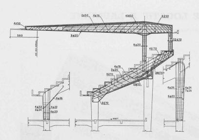
Fig. 4. — Disposition générale des armatures.
