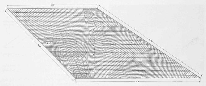
Fig. 9. — P. S. de Villeneuve. Armature de la dalle du pont.
