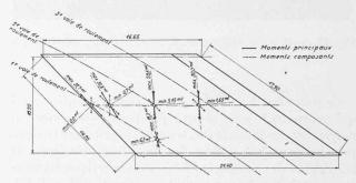
Fig. 6. — P. S. de Villeneuve. Moments principaux et directions principales pour quelques points.
