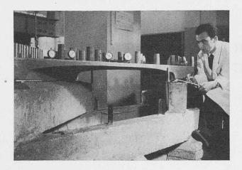
Fig. 16. — Pont d'Aigle. Modèle réduit chargé.
