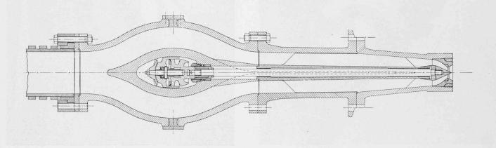
Fig. 7 a. — Centrale de la Dixence : Coupe horizontale d'un injecteur rectiligne bifurqué.
