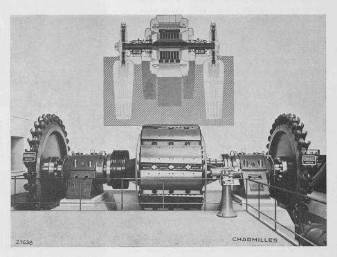
Fig. 5. — Centrale de la Dixence : Rotor d'un groupe présenté à l'Exposition nationale à Zurich, 1939.
