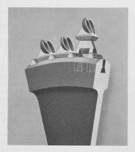
Fig. 2. — Centrale de Fully : Mode de fixation des aubes.
