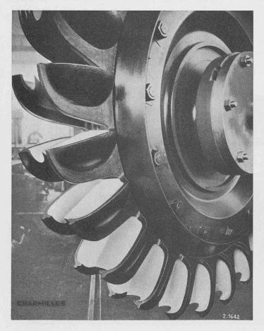
Fig. 13. — Centrale de Salanfe-Miéville: Roue de 47 500 ch constituée par un disque, une couronne de 26 aubes et une éclisse.
