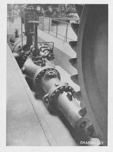
Fig. 7 b. — Centrale de la Dixence: Injecteur rectiligne bifurqué, à l'Exposition nationale à Zurich, 1939.
