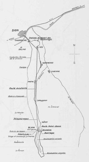
Fig. 2. — Situation générale des installations pour la construction du barrage.
