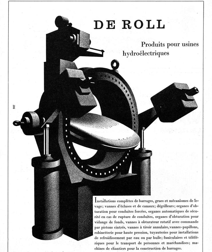
Vannes-papillons, pour conduite forcée, à fermeture automatique en cas de rupture de conduites
