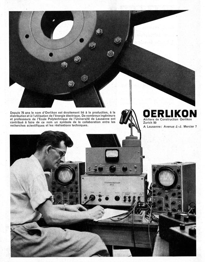
Mesure des vibrations, sur notre plate-forme d'essais de grandes machines.
