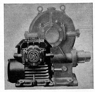
Refroidissement forcé, circulation d'huile à l'engrenage et aux roulements, profil des filets D. Brown, charge et rendement élevés malgré dimensions réduites, moins cher pour puls-sance donnée que réducteur à vis ordinaire, sûr, silencieux Types et rapports les plus courants livrables de suite par l'agent général
