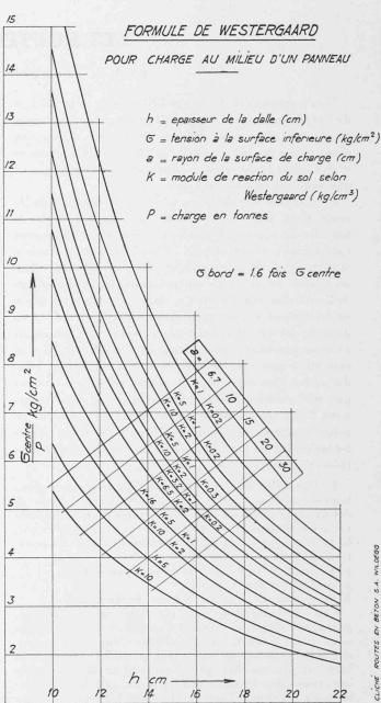
Fig. 2. — Courbes donnant pour une charge de 1 tonne agissant au centre d'un panneau, la tension maximum  $\sigma$  à la couche inférieure, en fonction de l'épaisseur de la dalle, pour différentes valeurs de a et de K. Remarquons qu'une courbe valable pour une paire de valeurs  $a_1$  et  $K_1$  l'est aussi pour  $a_1$ : 1,5 et  $K_1 \times 5$ , car  $\log 5 = 4 \log 1,5$  à une approximation suffisante.
