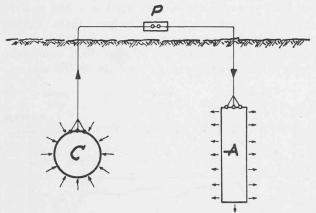
Fig. 2. — Protection par anode réactive. C = conduite; A = anode réactive; P = pav'e de contrôle.
