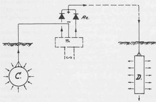
Fig. 4. — Protection par soutirage de courant. C = conduite; Tr. = transformateur; Re = redresseur (fer sélénium, p. ex.); D = déversoir.
