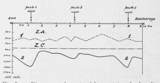
Fig. 5. — Diagramme des potentiels avant (courbe 1 — 1) et après (courbe 2 — 2) la protection par soutirage de la conduite de Esch-Bascharage.
