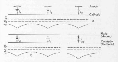
Fig. 3. — Variantes de la protection cathodique : a) Protection à l'aide d'anodes séparées ; b) « Drainage » et « soutirage » en différents points ; c) « Drainage » et « soutirage » au même endroit.
