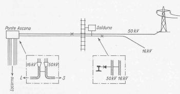
Fig. 7. — Câbles à haute tension Locarno-Ponte Ascona-Solduno.
