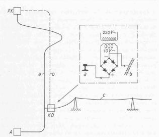
Fig. 4. — Protection cathodique du câble à haute tension « Klein Durren » (KD) — Pilatuskulm (PK).
