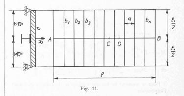
Sous l'effet de la réaction R de AB, les poutres  $b_i$ , toujours supposées appuyées aux deux bouts, prennent, vers le haut, une flèche dont l'expression (approchée) est
