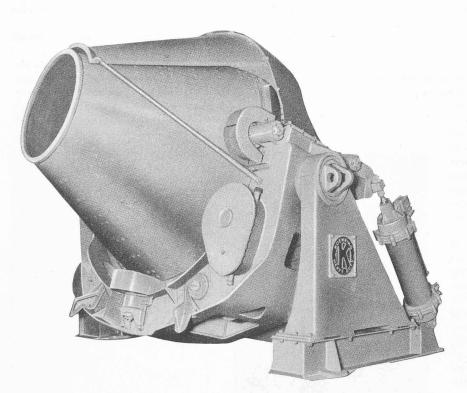
Fig. 2. — Bétonnière Koehring à zone de mélange concentrique d'env. 3000 litres de capacité à la gâchée.
